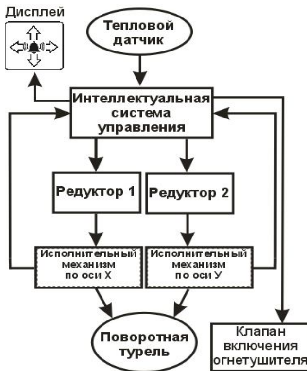
Рисунок 2 — Блок-схема управления огнетушителем
