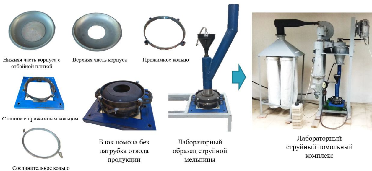
Рисунок 3 — Лабораторная установка струйного помольного комплекса
