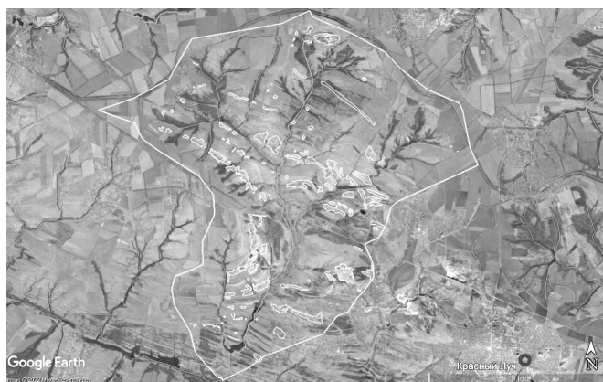
Рисунок 1 — Размещение карьеров, отвалов и карьерно-отвальных комплексов в бассейне реки Миусик
