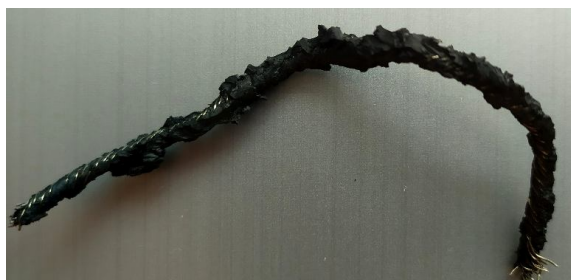
Рисунок 2 — Образцы металлического корда с вкраплениями резины (до пиролиза)
