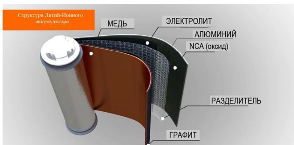
Рисунок 3 — Структура литий-ионного аккумулятора
