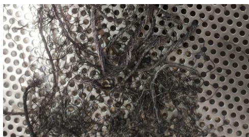
Рисунок 4 — Металлический корд после процесса просева
