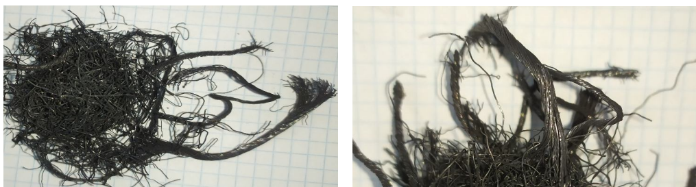
Рисунок 3 — Образцы металлического корда, прошедшего процесс пиролиза (слева) и механообработку (справа)
