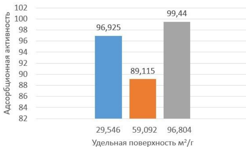
Рисунок 2 — Зависимость адсорбционной активности от удельной поверхности
